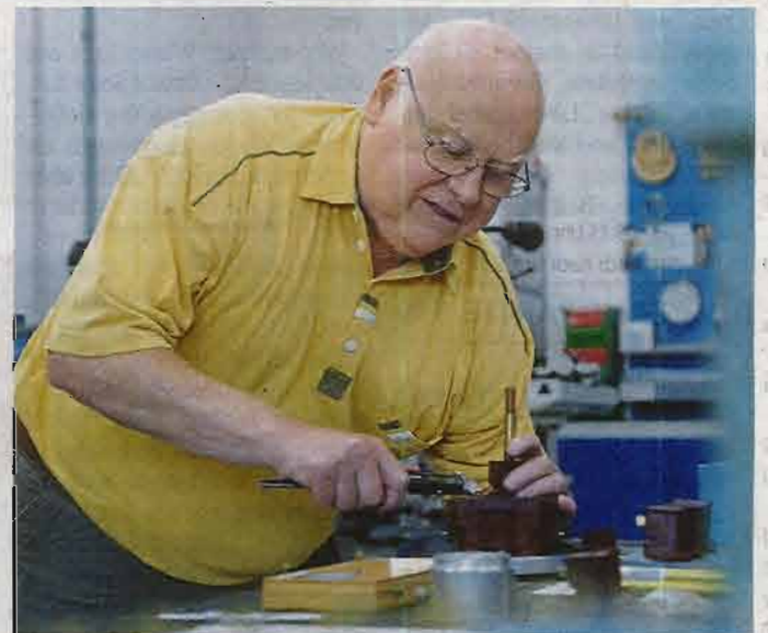
Routine und Expertise pur: Werkzeugmacher Werner Feick (75) beim Prüfen eines Verteilerläufers für den Mercedes SSK.
